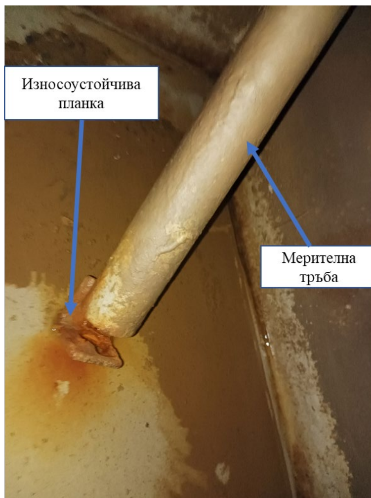
Фиг.2. Износоустойчива планка на мерителна тръба[7]
